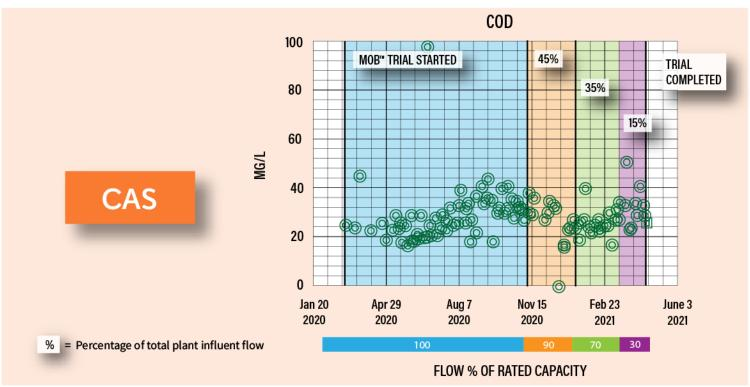
MOB™ PROCESS COD CONSUMPTION INCREASED AS FLOW INCREASED, MAINTAINING COD EFFLUENT LEVELS
